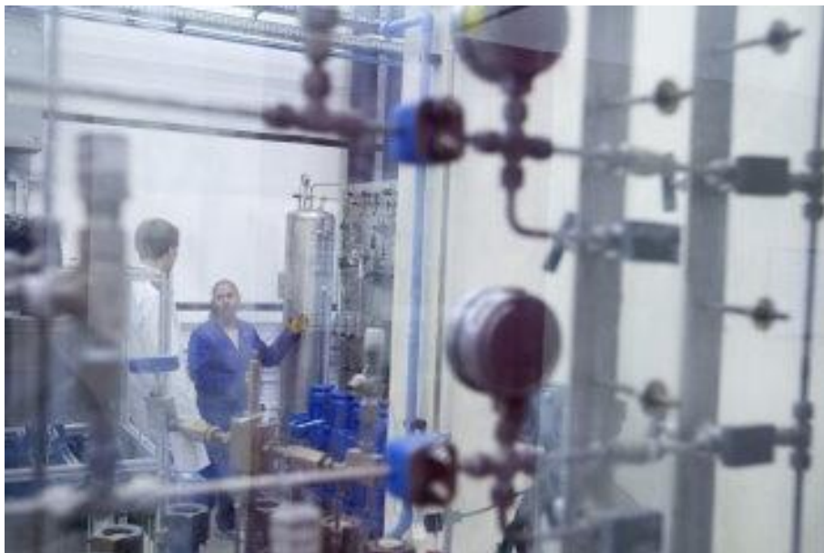
Figure 6 : installation d'essai pour le circuit primaire de centrale nucléaire
